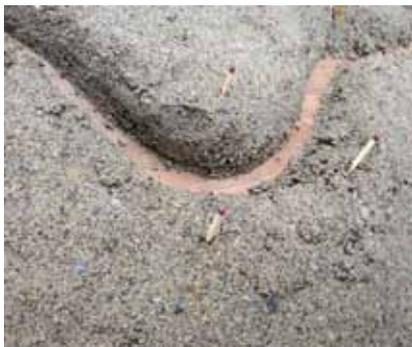
An den Aussen- und Innenseiten der Kurven, nahe des Flussbetts, 10 Streichhölzer ca. 1 cm tief in den Sand stecken. Sie symbolisieren Pflanzen, welche in der Nähe des Flussbetts wachsen und durch die ständige Erosion am Flussufer gelegentlich weggespült werden.
